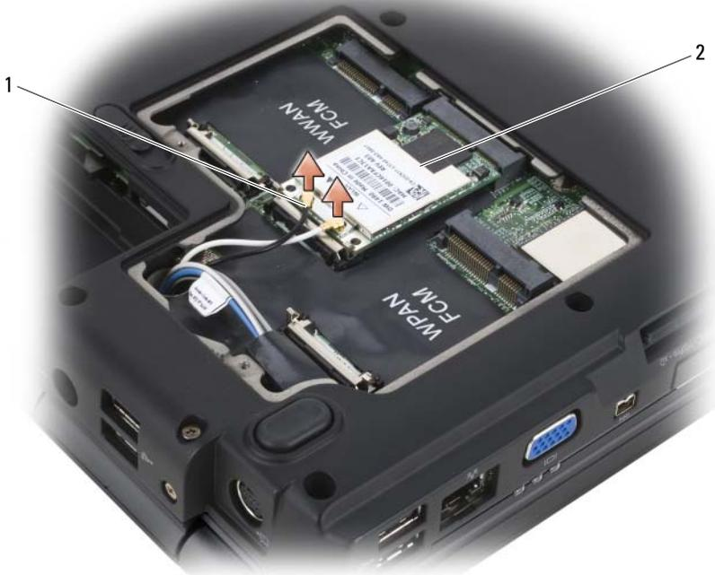
1 Antennenkabelanschlüsse (2)      2 WLAN-Karte
