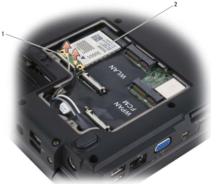
**1** Antennenkabelanschlüsse (2)      **2** WWAN-Karte
