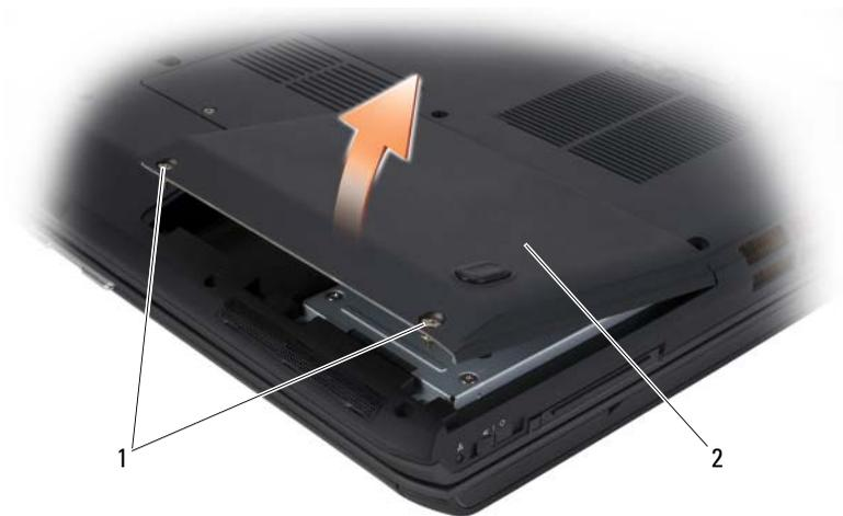
1 Unverlierbare Schrauben (2) 2 Abdeckung des Festplattenschachts
